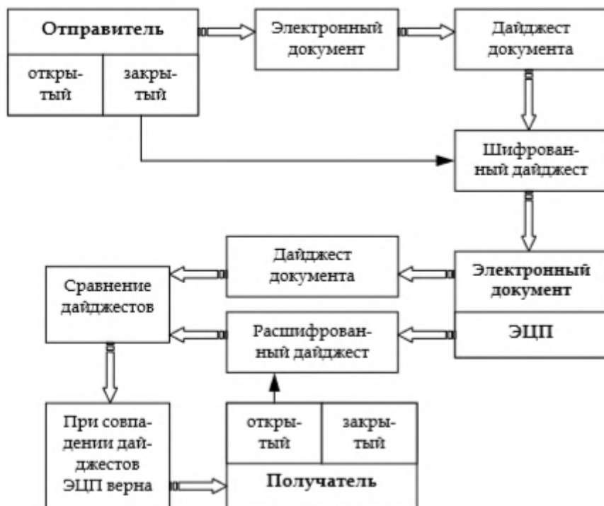
Рис. 1. Технология электронной цифровой подписи
