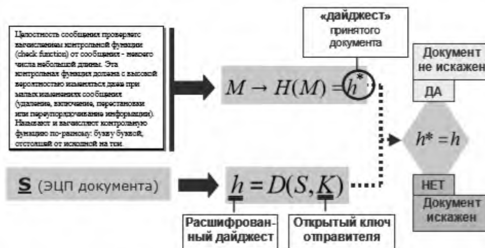
Рис. 8. Алгоритм верификации ЭЦП.
