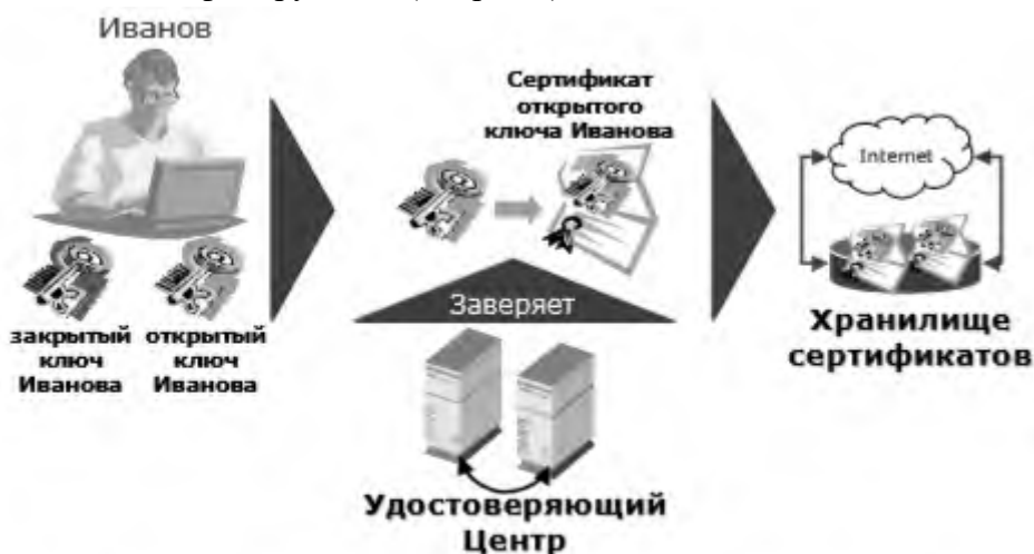
Рис. 5. Схема формирования сертификата открытого ключа.
